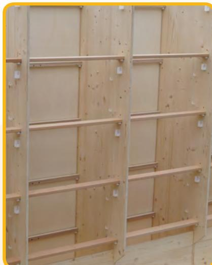
Die Sitzleisten aus Buchen Holz auf die Metallbolzen an den aufrechten Seitenwänden aufdrücken. 4 Stück je Zellenreihe. Die Kerbe in den Leisten muss dabei immer nach hinten zeigen. Wichtig: Bei der Zellengröße 69,2 cm sind die Leisten mit Nr.1 und Nr. 2 gekennzeichnet. Die Leisten mit der Nummer 1 kommen in die oberste Zellenreihe. Die Leisten mit der Nr. 2 in die zweite Reihe von oben usw.
