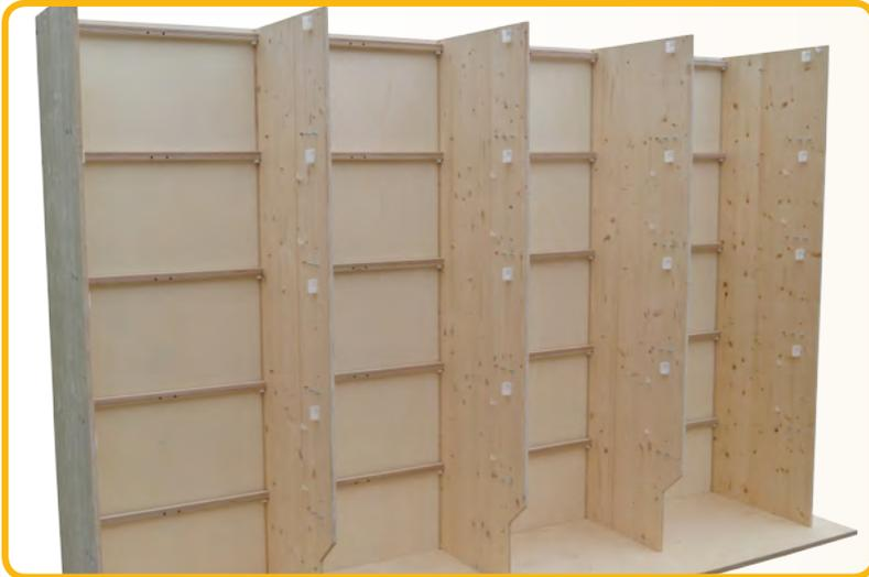
Fall der Schrank mit Rückwand geliefert wird, die Rückwände in die Nutleiste hinten an den Seiten stecken. Dann die hinteren Querleisten mit dem Maß 19 x 27 mm von oben nach unten auf die Metallbolzen an den Seitenwänden aufstecken. Insgesamt 5 Leisten. Die Bohrung der hinteren Leisten muss dabei immer nach vorne zeigen.
